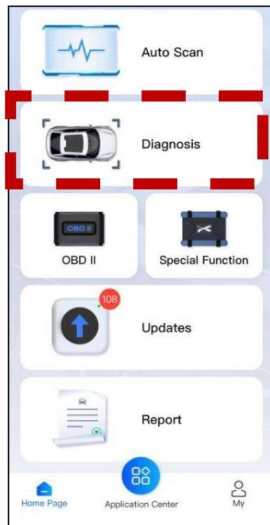
Pour certaines marques de véhicules (comme Volkswagen), lorsque vous cliquez sur le logiciel, il existe plusieurs façons de sélectionner le modèle ou le système sur lequel vous souhaitez effectuer un diagnostic. y compris la détection automatique, la sélection manuelle et la sélection du système.
